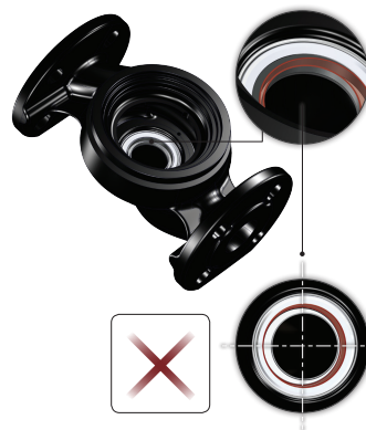
Nesprávně vystředěná těsnicí soustava
