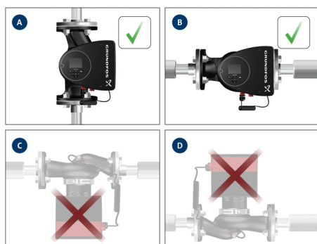
Čerpadlo instalované s horizontální hřídelí motoru
