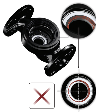
Nesprávně vystředěná těsnicí soustava
